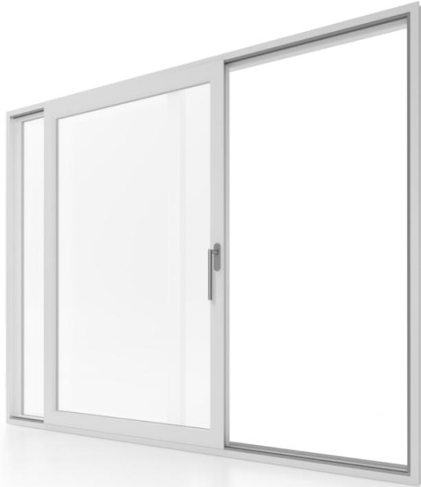
**70mm Bautiefe** | 1,4 W/m<sup>2</sup>K bester Uf-Wert | bis zu RC2 Sicherheit | bis zu 41mm Glasstärke
